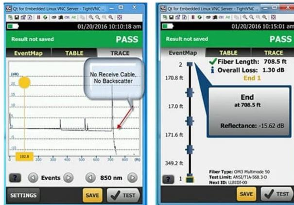
Figura 4. Sem um cabo de recepção ou "tail", o desempenho do último conector não pode ser observado.
