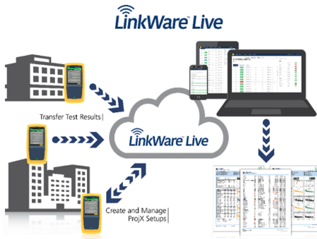
Figura 4. Com o LinkWare Live, os gerentes de projeto podem criar e gerenciar configurações de teste e transferi-las para testadores. Os técnicos podem carregar os resultados dos testes, permitindo que os gerentes de projeto acompanhem o progresso do trabalho.
