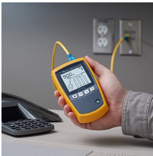
Figura 5. O MicroScanner PoE é certificado pela Ethernet Alliance Gen2 PoE e pode detectar a potência fornecida pelo PSE, mais a velocidade da rede, e conta com um conjunto de recursos para teste de cabeamento.
