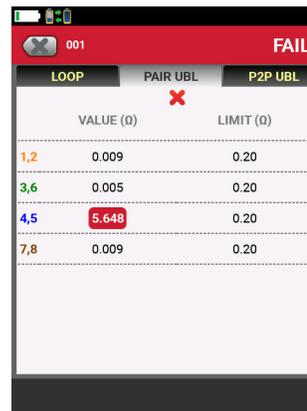
Resistência excessiva que poderia causar uma conexão intermitente
