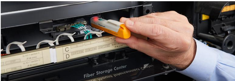
Determine se uma porta está ativa. O tamanho pequeno facilita o acesso a painéis de conexão estreitos.
