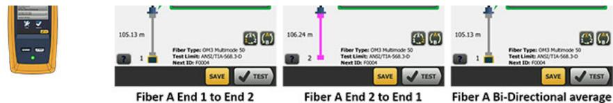
Figura 6: SmartLoop mede cada fibra em ambas as direções e depois calcula um resultado em média para cada direção. Os usuários podem alterar a visualização, usando os dois botões no canto inferior direito da tela. Exibido (esquerda para a direita): Extremidade 1 da fibra A à extremidade 2; Extremidade 2 da fibra A até extremidade 1; resultado médio da Fibra A.
