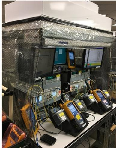
*Figura 2 - Estação de calibragem de fibra. Observe o plástico em torno da estação na parte superior do sistema de filtração para reduzir a poeira. Alguns dos produtos comercialmente disponíveis usados são modificados pela Fluke Networks para atender aos nossos requisitos de precisão.*
