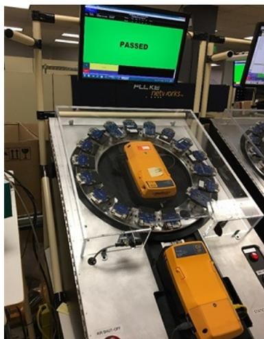
*Figura 1 - Estação de calibragem de cobre. Dezessete instrumentos personalizados são conectados à unidade Versiv em sequência para calibrá-lo. A configuração automática de roda é usada apenas na fábrica para lidar com volumes de produção.*
