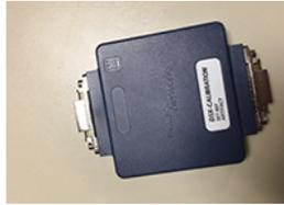
Figura 3 - Um dos dezessete instrumentos de calibragem de cobre usados em nossos centros de serviço. Com revestimento plástico para proteção.
